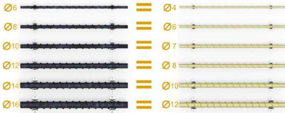
Рис. 4. Разница диаметров композитной и металлической арматуры.
