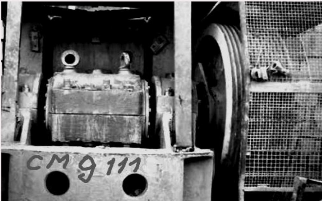
Рисунок 3. Общий вид щековой дробилки СМД111 после аварии
