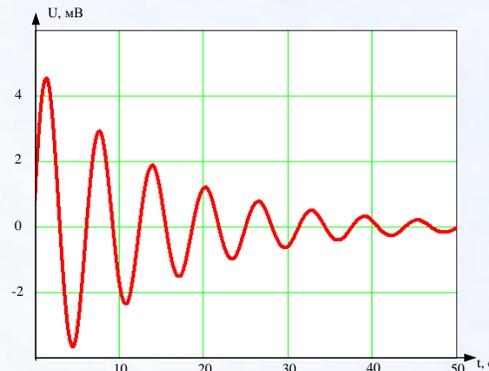
Рис 4. Кривые вибрации контактного провода измераемым акселерометром.
