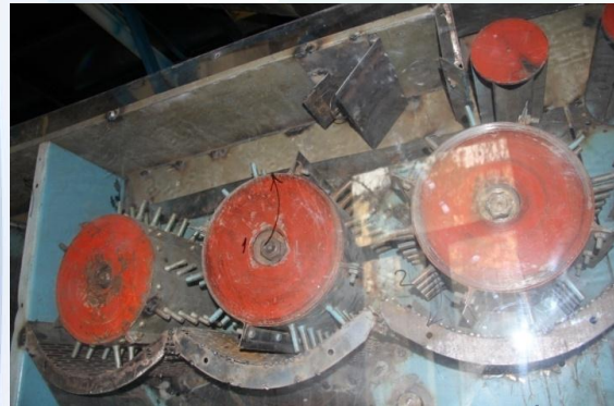
1-расм. Лаборатория стендига пружинали қайтаргич ва камера деворига ўрнатилиши
