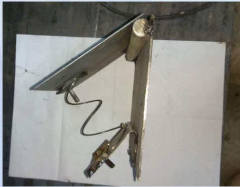
1-расм. Лаборатория стендига пружинали қайтаргич ва камера деворига ўрнатилиши
